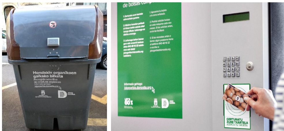
Figura 3. Contenedor con cerradura de apertura mediante tarjeta electrónica (izquierda); y, máquina expendedora de bolsas compostables en San Sebastián (derecha). Fuente: Institut Cerdà y Ayuntamiento de San Sebastián, 2018.
