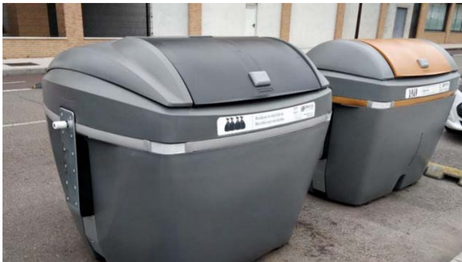
Figura 3. Contenedores con control de acceso para el depósito de fracción resto y residuos orgánicos, en el marco del proyecto europeo WINPOL. Fuente: Web Oficial de Gijón, 2021.
